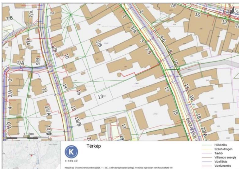
A módosítással érintett tömb közmű-kapcsolatai
