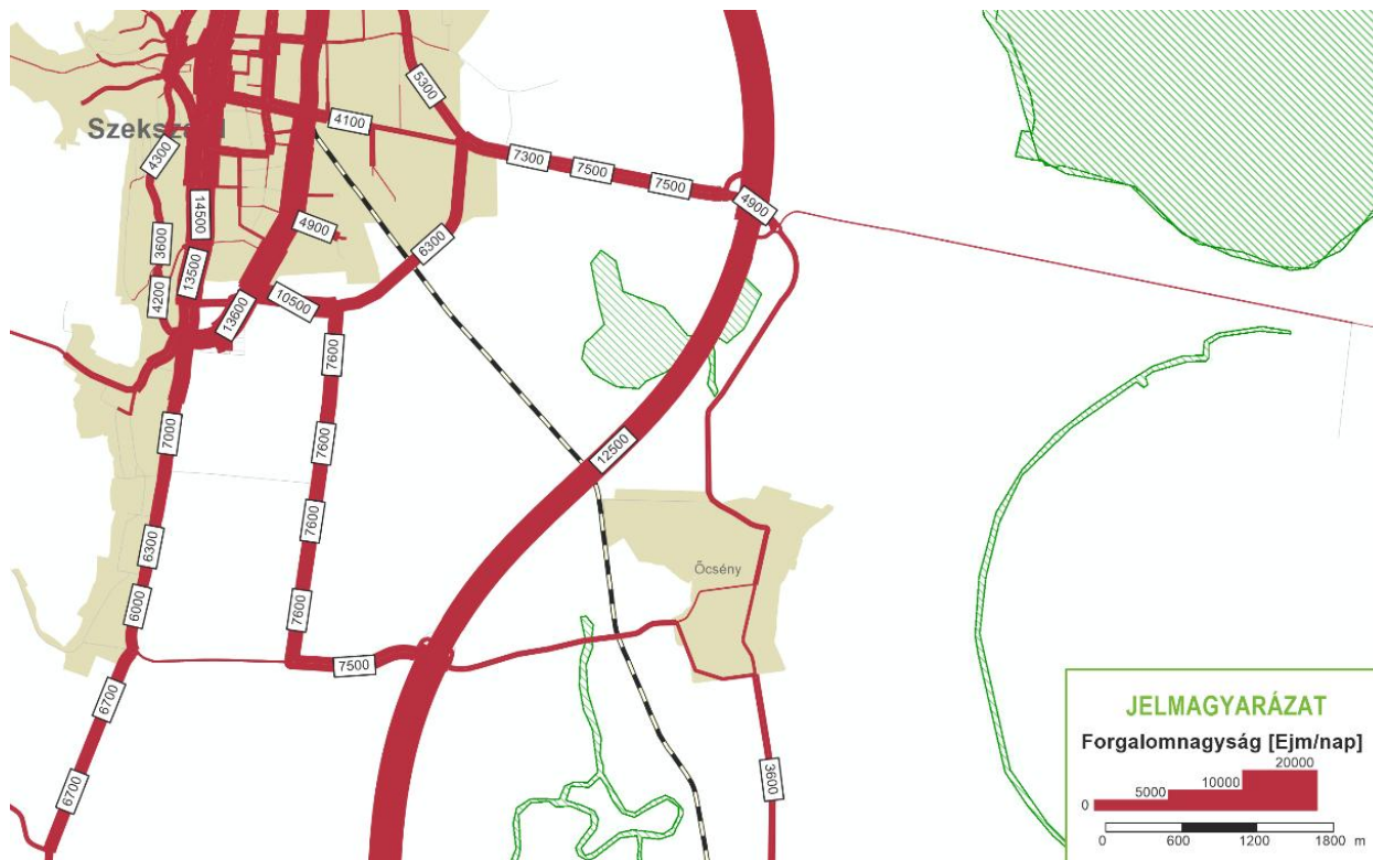
63. ábra Várható forgalom (ÁNF) II. ütemben (2040-ig) a Keleti elkerülő út déli szakaszának fejlesztése révén az I. ütemhez képest (TRENCON Forgalmi modell)
