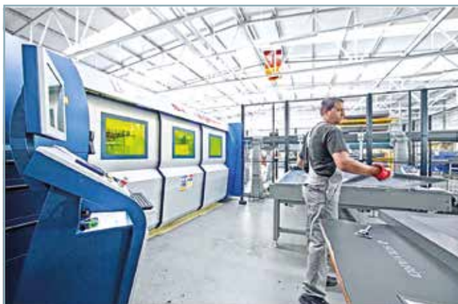
Ez a lézerberendezés teljesen automatikus berakodással készíti az összetett kontúrokat, a gépkezelők átfogó oktatást kapnak a legújabb technológiákról
